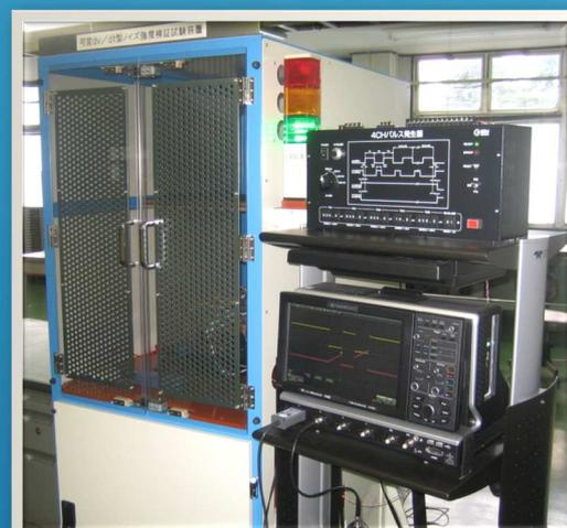
製作例) 可変dv/dt型ノイズ強度検証試験装置
